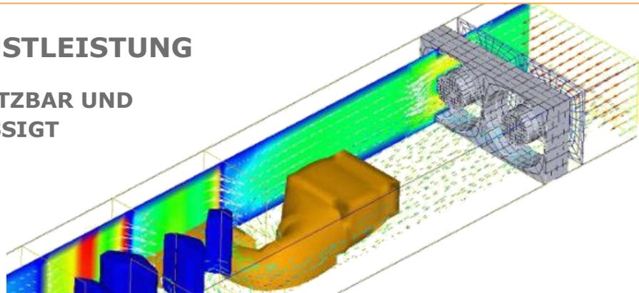
**Der Weg zur Verlustleistung führt über den Arbeitspunkt der individuellen Geräte Kennlinie eines Lüfters.**
